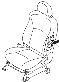
โมดูลถุงลมนิรภัยด้านข้าง (ชายและขวา)
