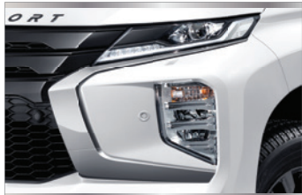
ไฟหน้าโปรเจกเตอร์ธรรมดา แบบ Bi-LED พร้อมระบบปรับระดับลำแสงไฟอัตโนมัติ
